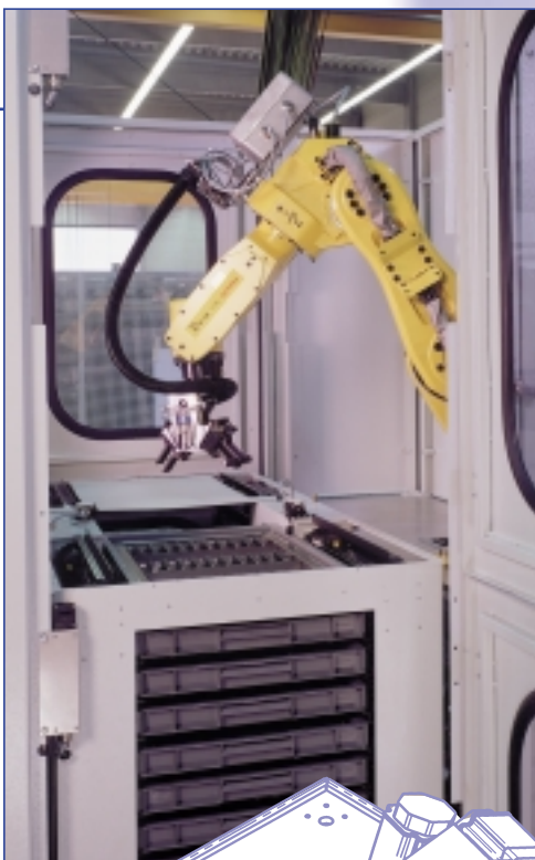
Doppelgreiferkopf bei der Teileabgabe zum Palettierer
